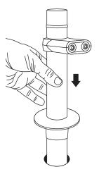
Setzen Sie den Sondenfuß der Bohrlochsonde in das Bohrloch ein, welches über einen Durchmesser von 50 mm (± 2 mm) verfügen sollte.
