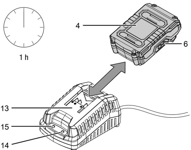
2. Stecken Sie den Netzstecker des Schnellladegerätes (13) in eine ordnungsgemäß abgesicherte Netzsteckdose.
