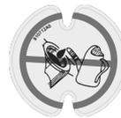
Ce symbole indique qu'il ne faut pas verser d'huile liquide dans l'orifice de remplissage ou le porte-outil. Utilisez uniquement de la graisse machine.
