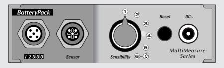
Anschluss des ausgeschalteten Messgerätes T2000 und schließen das freie Ende des Verbindungskabels am T2000-Anschluss des BatteryPack an.
