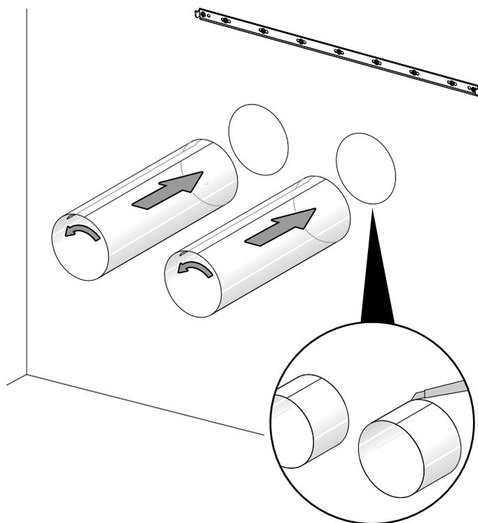
10. Mettez en place l'anneau de fixation intérieur du cache d'évacuation d'air sur le côté intérieur de l'ouverture d'évacuation d'air.
