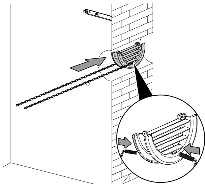
13. Dépliez le cache extérieur avant de fixer les chaînes en les accrochant à l'anneau de fixation intérieur. Le cache extérieur est ainsi maintenu fermement en position.
