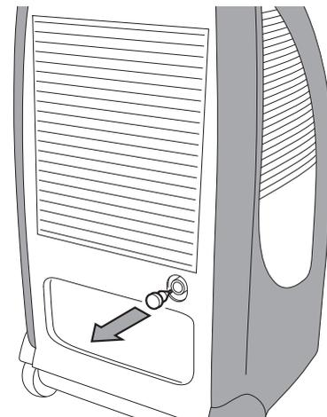
2. Schieben Sie das eine Ende des Schlauches auf den Schlauchanschluss.
