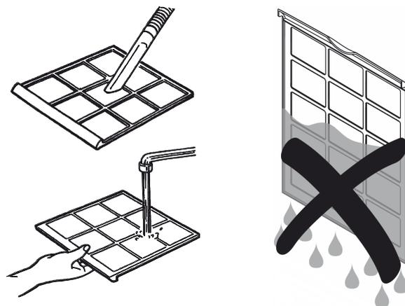
3. Lassen Sie den Filter komplett trocknen. Setzen Sie keinen nassen Filter in das Gerät ein!
