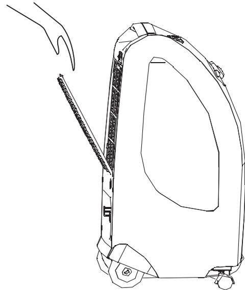
2. Säubern Sie den Filter mit einem weichen, fusselfreien, leicht angefeuchteten Tuch. Sollte der Filter stark verschmutzt sein, säubern Sie ihn mit warmem Wasser, vermischt mit neutralem Reinigungsmittel.
