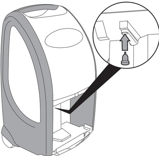
5. Setzen Sie den Kondensatbehälter wieder in das Gerät ein. Beschädigen Sie beim Einsetzen und Herausnehmen des Kondensatbehälters nicht den Schwimmer. Achten Sie dabei darauf, dass der Schwimmer richtig positioniert ist. Achten Sie dabei darauf, dass der Kondensatbehälter richtig eingesetzt wird, sonst schaltet sich das Gerät nicht wieder ein.
