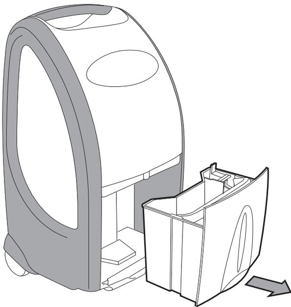
2. Entleeren Sie den Kondensatbehälter über einem Abfluss oder Spülstein.
