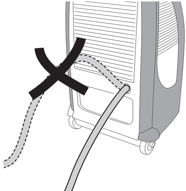
Entfernen Sie den Schlauch, wenn Sie das Kondensat wieder über den Kondensatbehälter auffangen wollen. Lassen Sie den Schlauch vor der Lagerung trocknen. Der Schlauch kann in jeder beliebigen Betriebsart zum Dauereinsatz angeschlossen werden.
