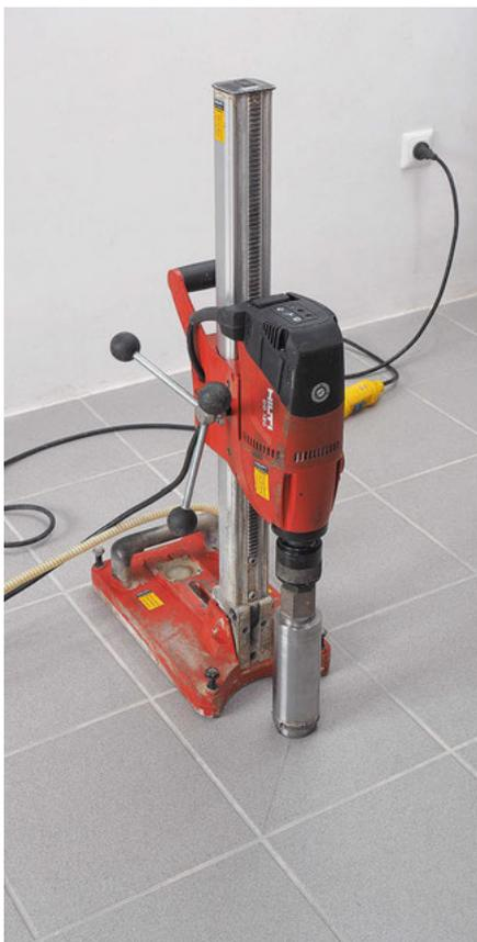
Die Duplex-Bohrkrone können Sie problemlos mit einer beliebigen professionellen Bohrmaschine aus Ihrem Bestand einsetzen. Die zusätzliche Anschaffung teurer Spezialbohrgeräte ist nicht erforderlich.
