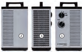
Ein doppelter Lufteinlass an der Vorder- (1) und Rückseite (2) des Heizgerätes versorgt das leistungsstarke Radialgebläse großvolumig mit Ansaugluft, die dann als Warmluftstrom vollflächig über das seitliche Ausblasgitter (3) in den Raum geblasen wird.
