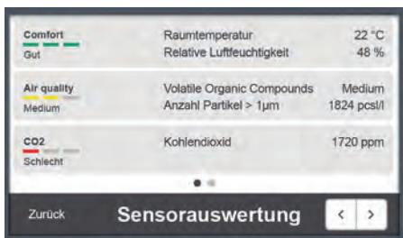
Der AirgoClean® One zeigt übersichtlich alle erfassten Raumluftqualitätswerte an – numerisch und als Ampelfarbbalken: Temperatur und Luftfeuchtigkeit, VOC-Konzentration, Feinstaub-Belastung oder Kohlendioxid-Konzentration.
