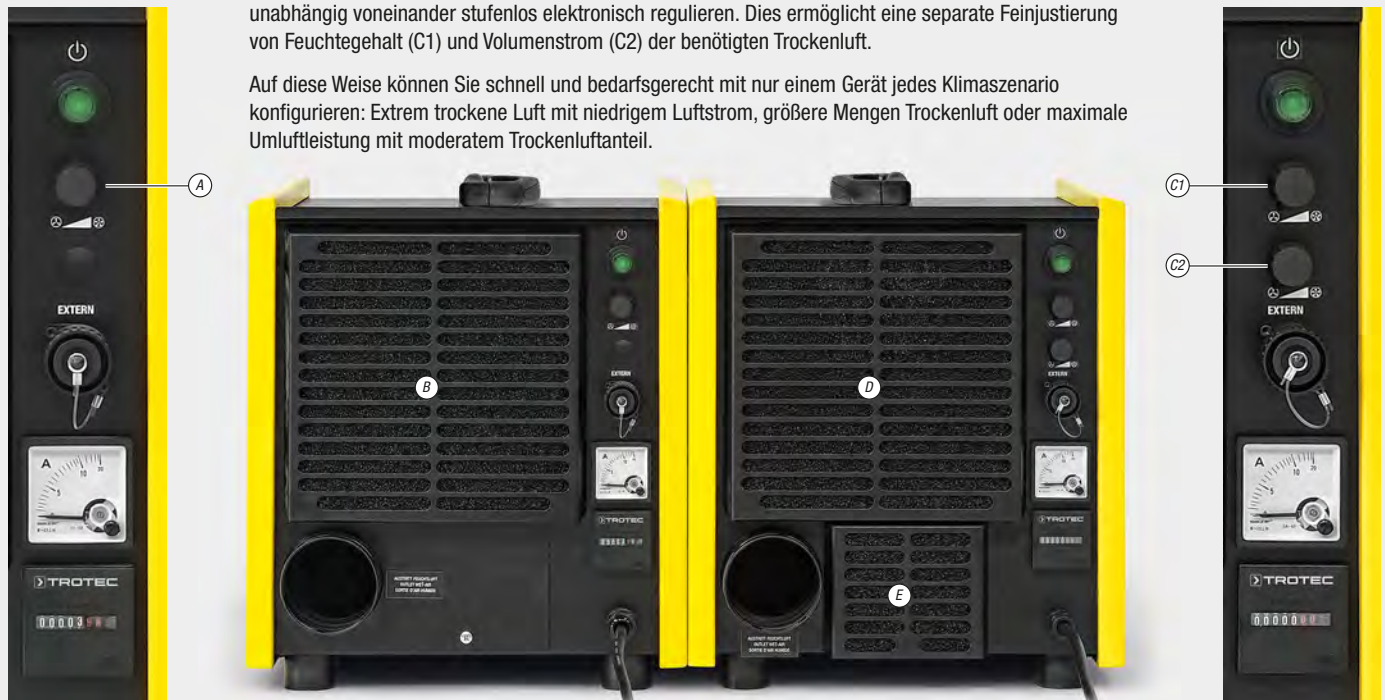
Die Modellunterschiede im Direktvergleich: Auf der linken Seite ein TTR 400 mit Monoventic-Luftmengenregulierung (A) und kombiniertem Eintritt für beide Luftströme (B), rechts ein TTR 400 D mit Duoventic-Regelung (C1, C2) und separaten Eintritten für Trockenluft (D) und Regenerationsluft (E).
