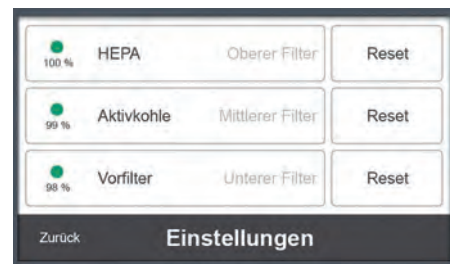
Der Luftreiniger informiert Sie über den Verbrauchszustand der installierten Luftfilter und zeigt einen notwendigen Filterwechsel an.
