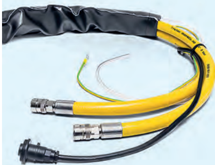
Installationsfreundliches Verbindungsset mit schutzummantelten Leitungen für Kühlmedium (Schnellverschlussskupplung), Kondensatabfuhr, Strom- und Erdungsanschluss.
