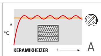
Trotec-Heizlüfter mit PTC-Keramikheizelementen (A) zeichnen sich gegenüber konventioneller Heizwendeltechnik (B) nicht nur durch ein schnelleres Aufheizverhalten aus. Verfahrensbedingt ergeben sich außerdem deutliche
