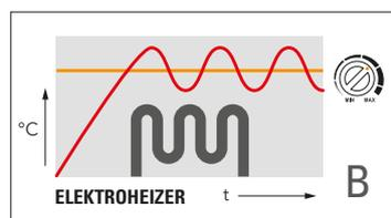
durch die Spirale oder das Gitter auskühlt, und später wieder vom Thermostat aktiviert, sodass sie sich erneut voll aufheizt bis zur nächsten Abschaltung bei Erreichen der eingestellten Zieltemperatur. Dieser „Ein-/Aus-Prozess“
