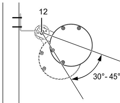
8. Une fois l'appareil incliné à l'angle souhaité, resserrez les deux vis six pans creux (12).
