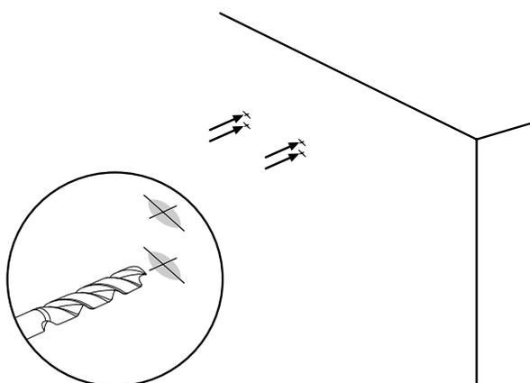
3. Mettez en place les vis à frapper fournies dans les trous, sans les rondelles ni les écrous.
